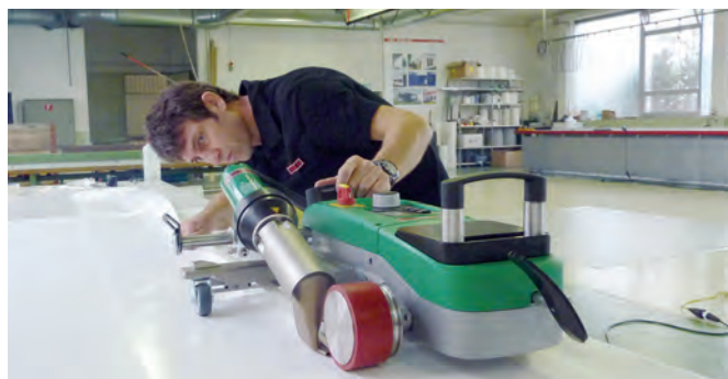
Souprava pro snadné svařování lemu se šňůrou, a nebo bez.
